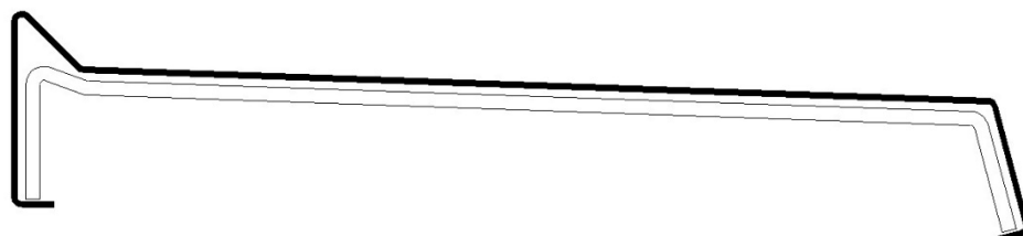
Figuur 5 - Muurafdekprofiel met kraalkapmodel geen afschot
