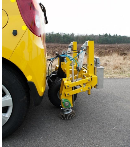
Figuur 2 Veeginstallatie FCM
