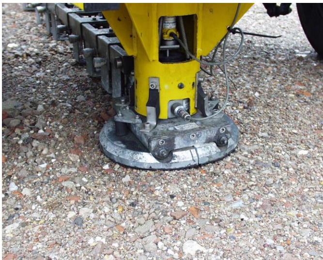
Figuur 3 Dynamische plaatbelastingsproef door Kiwa KOAC
